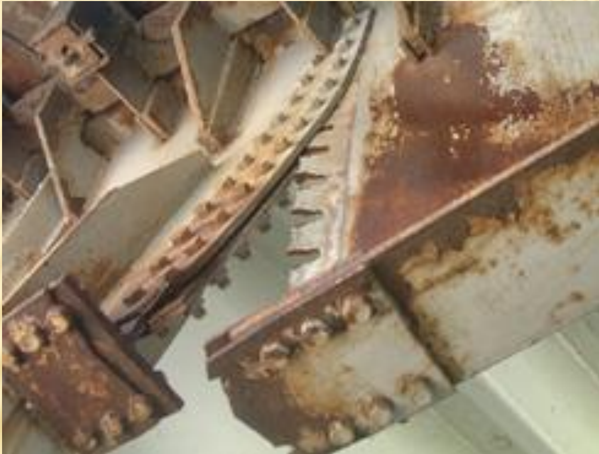
Figure 65 : Sur ouvrage d'art, rupture par dépassement des efforts en pression diamétrale pour l'âme, par excès de traction pour le couvre-joint de la membrure inférieure.
